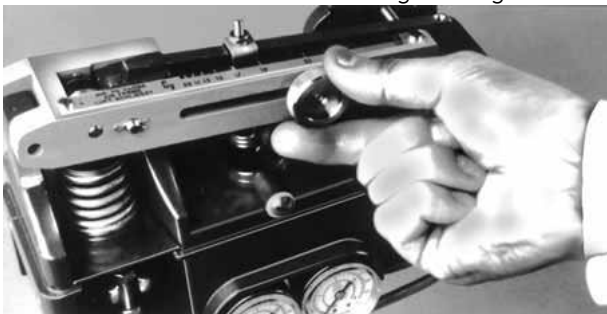
Abbildung 4 - Einstellung des C_v Werts eines VariPak 28002 für jedes Verschlusssteil und jede Sitzring-Kombination
